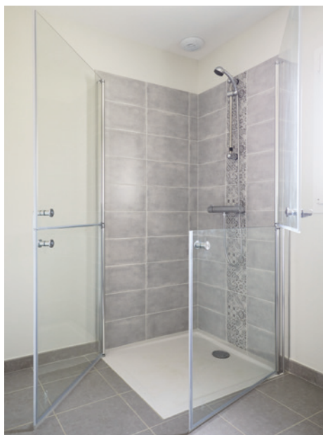
Exemple de douche totalement adaptée : la séparation de la paroi en deux parties permet à l'aidant de pouvoir s'occuper de la personne tout en restant au sec.
